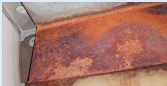
エアシールが破れ、リークにより内部が結露し、腐食の原因になります。濃縮率のダウンにも繋がります。
