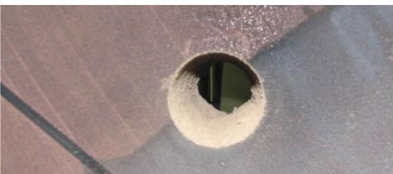
ローター素子の一部をくり貫き、調査を行うことで、性能低下の原因や、現在のVOCの吸着状態を通常のデータと比較することができます。サンプリング後は新しい素子を埋め込み、ローターは再使用できます。
