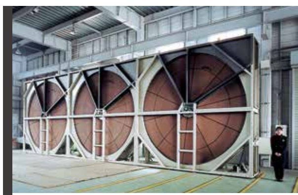
VOC濃縮カセット (UZC-3950V45×3連) 風量：160,000m³/hr VOC：IPA、トルエン、etc. 納入先：印刷工場
